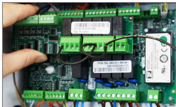
4. Paina laajennuskortti oikeaan kohtaansa pääpiirikortilla.
